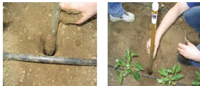
Слика 5. Поставување на тензиометар на постојано место (на поле) (извор, Чукалиев и Танасковиќ, 2007)
